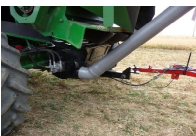
Bac d'extraction et remorque de récupération des menues pailles
